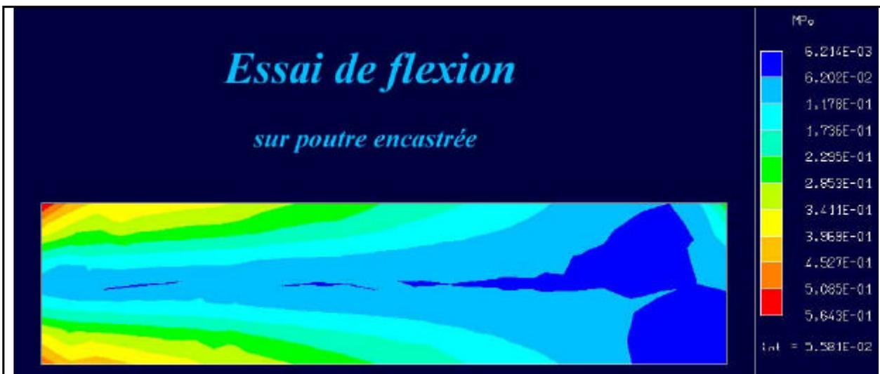
La même poutre est maintenant soumise à de la flexion pure. Elle est encastrée à gauche et soumise à un effort ponctuel à son extrémité droite. Nous remarquons alors que la contrainte est plus importante au niveau de l'encastrement et du point d'application de la charge. On note également que la ligne moyenne n'est presque pas chargée par rapport au reste de la poutre.
